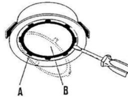
La petite lampe halogène peut maintenant être retirée du spot. Soyez prudent afin que la lampe ne tombe pas directement vers le bas, mettre alors quelque chose sur votre plaque de cuisson pour la protéger. Ne touchez pas la nouvelle lampe halogène avec les mains, ça réduit l'intensité de la lumière. Remplacez la lampe défectueuse par une nouvelle lampe du même type avec la même puissance (20 Watt). Montez ensuite le verre et le bord à nouveau dans le spot.
